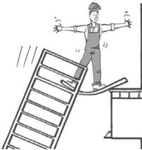
◀ **FIG. I:** Está prohibido realizar conexiones en puente entre una torre de trabajo móvil y un edificio u otra estructura que no forme parte del andamio de trabajo móvil.
