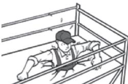
◀ **FIG. N:** Está prohibido saltar sobre las tarimas o apoyar sobre ellas cargas o personas que pesen más respecto a la capacidad declarada por el Fabricante. No se admite aumentar la altura de las tarimas mediante escaleras, cajas u otros dispositivos y no deben montarse protecciones de ningún tipo como enrejados, toldos o demás.
