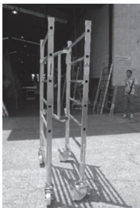
► Fig. B. **Apertura base.** Colocar el módulo base en posición vertical y abrirlo como muestra la foto
