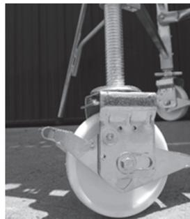
**Ruedas 200mm:** Colocar el vástago en el orificio, y apretar con la palometa, a continuación apretar las ruedas por debajo de la mordaza hasta el disco.
