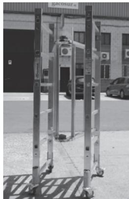
► **Fig. B.** Apertura base. Ubicar el módulo base en posición vertical y abrirlo como en la foto.
